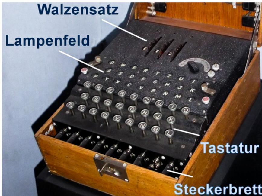
Enigma Verschlüsselungsmaschine mit Beschriftung
